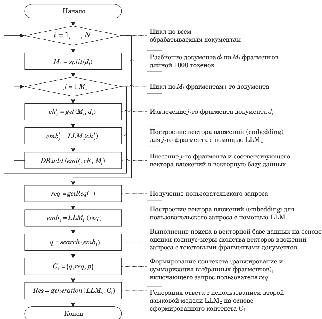
■ Рис. 5. Алгоритм семантической разметки и извлечения информации из слабоструктурированных данных
