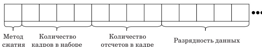
■ Рис. 3. Порядок записи бит служебной части данных при архивации
