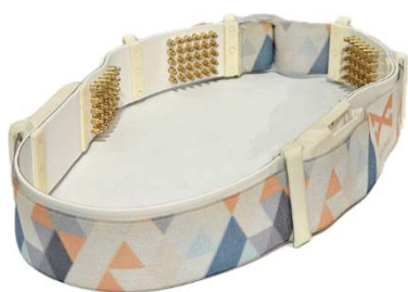
■ Рис. 2. Носимая головная повязка BrainBit, использованная для регистрации ЭЭГ-сигнала
