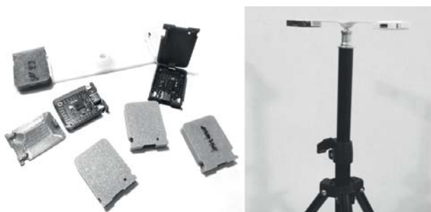
■ Рис. 3. Аппаратура экспериментальной установки на базе ESP32s2
